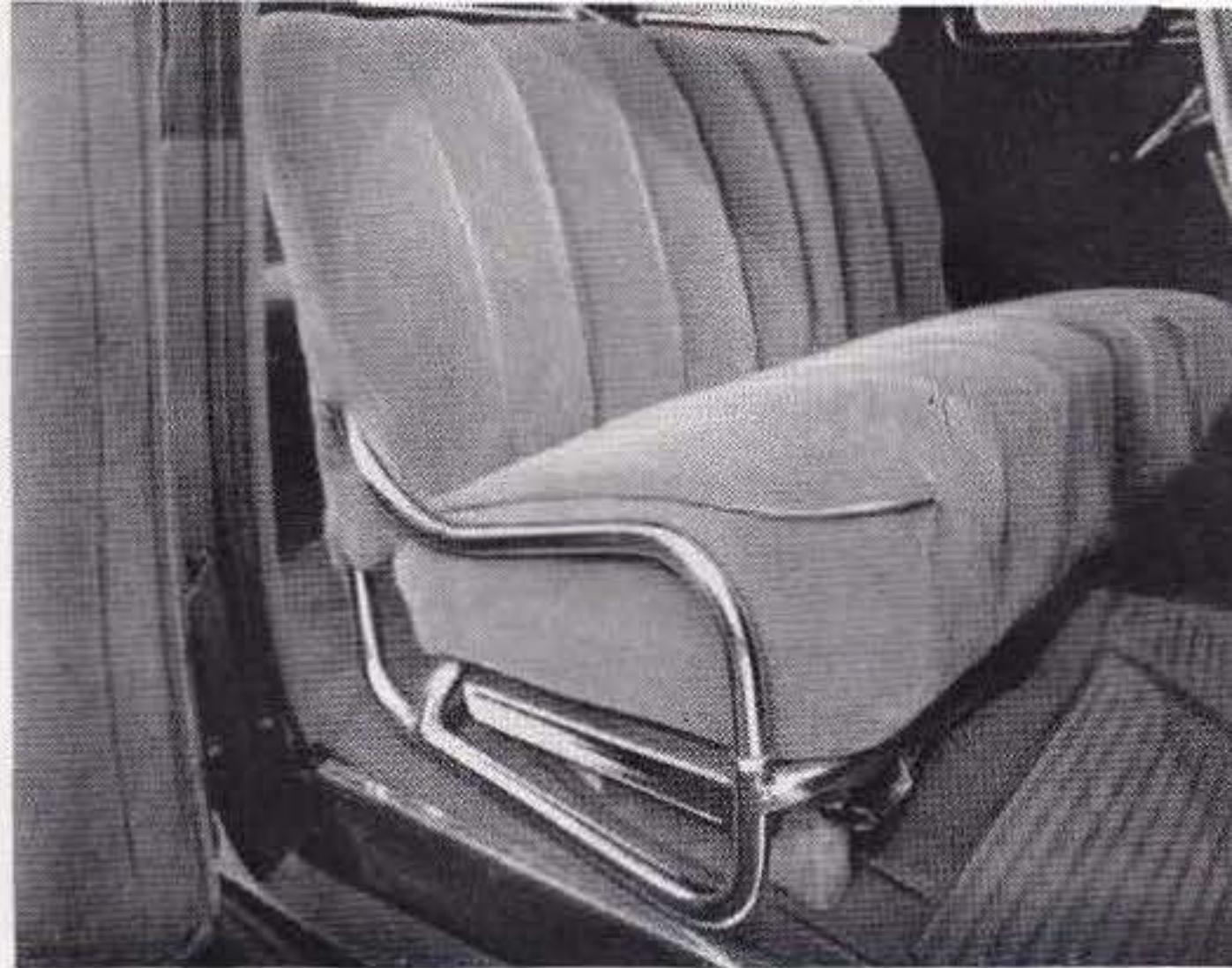
Nouveaux sièges tubulaires.
