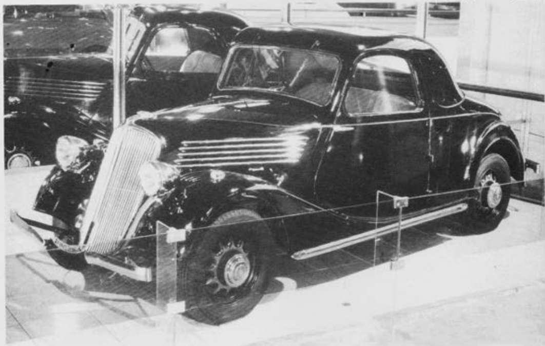
▲ Le cabriolet quatre places « Celtaquatre », 1936, appelé coach décapotable. Notez que le pare-brise est rabattable et remarquez la forme de la porte, propre aux cabriolets Renault de cette époque (sans rapport avec la porte des voitures fermées, faux-cabriolets compris).
