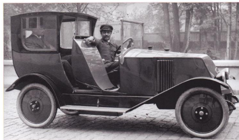
Une Renault 6 ch KJ en version taxi en 1923. Noter le rabattant d'accès qui fait « couvrir-jambes » pour le client.
